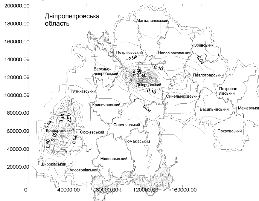
Рис. Розподіл викидів діоксиду азоту від основних джерел забруднення атмосфери (інтервал концентрацій між ізолініями – 0,10 \text{ мг/м}^3 )
