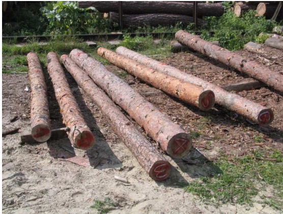
Рис. 8. Загальний вигляд частини відібраних соснових колод (колода № 1 перша ліворуч, основні розмірні характеристики: d=17 см; D=19,5 см; L=3,16 м)
