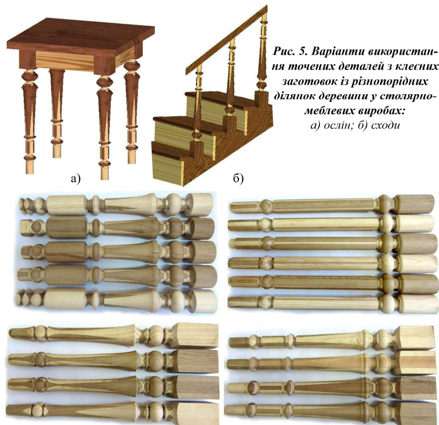
Рис. 6. Світлини виготовлених точених деталей з клеєних заготовок із поєднанням деревини дуба та сосни
